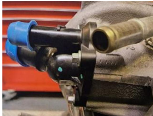
Figura 1 – Detalhe do tubo de refrigeração a tamponar.
