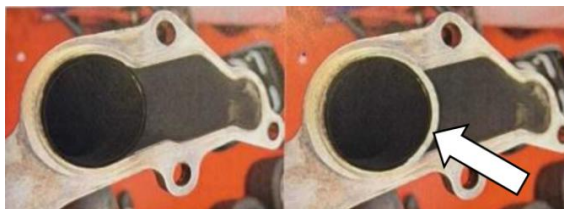
Figura 2 – Coletor de escape nº4 original (à esquerda) e modificada com adição de material (à direita).
