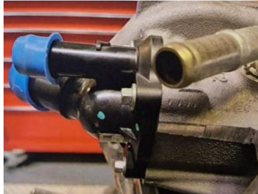
Figura 1 – Detalhe do tubo de refrigeração a tamponar.
