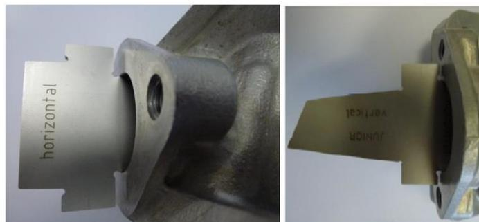
**6.4.11.** As dimensões horizontais e verticais da saída de escape (no cilindro Max, com a referência 223993, com a saída de escape totalmente mecanizada com CNC) deve-se verificar com a peça Rotax referência 676245\*.
