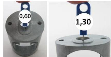
**6.10.9.2.** O calibre 1,30 mm da peça Rotax com referência 281920 não pode entrar no orifício vertical (conforme a imagem).
