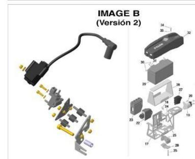
**7.13.2.** A caixa eletrónica é específica para a categoria DD2 Max e subcategoria DD2 Max Master e está marcada com um autocolante com o número da referência Rotax que é 666816. É permitido retirar o autocolante.
