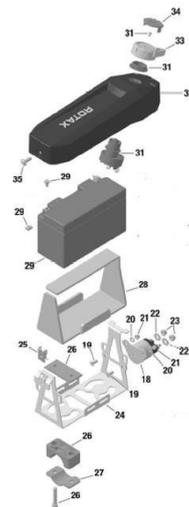
**b)** Na versão 2 a bateria deve estar fixada ao chassis através do suporte com a referência Rotax 251127 ou 251129 e apertada, no mínimo, por 4 parafusos, com a abraçadeira e tampa originais (referência Rotax 201602), com o botão de start e on/off (referência Rotax 264852). Também deve incluir o "relais", preso ao suporte (referência Rotax 992819) e o suporte do ECU.
