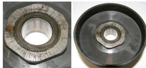
**6.8.6.** À entrada da pré-grelha os Comissários Técnicos, poderão, sempre que o entenderem, solicitar ao Condutor a desmontagem da campânula da embraiagem para verificação da existência de qualquer substância lubrificante, podendo utilizar um líquido ou «spray» para limpeza de qualquer tipo de lubrificante e/ou gordura que possa existir na campânula. Também poderão solicitar a substituição da campânula e/ou embraiagem por uma fornecida e sorteada pela Organização.
