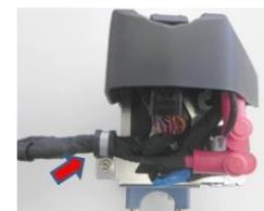
**6.7.7.3.** Nos motores 125 Micro MAX Evo, 125 Mini/Micro MAX Evo e 125 Junior MAX Evo, pode utilizar-se uma peça para tapar a ficha de ligação da válvula eletrónica, que tem como referência Rotax 666900.
