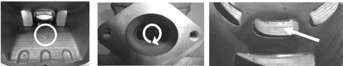
As dimensões horizontais e verticais da saída de escape (no cilindro Junior 223994, com a saída de escape totalmente mecanizada com CNC) deve-se verificar com a peça ROTAX referência 676240.
