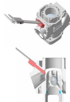
**6.5.10.2.** A medida máxima é de 25,0 mm. A medição tem de ser feita na zona superior e inferior da cavidade, girando a peça ROTAX 180 graus.
