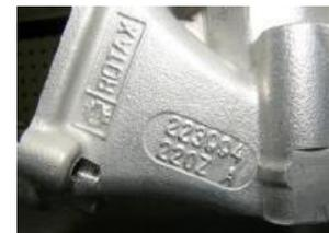
6.4.1.2. O cilindro do motor 125 Senior MAX Evo possui uma janela de escape principal e válvula de escape eletrónica é permitido o cilindro Single Core com referência Rotax 613372 e marcado com o número 223993, e logo "ROTAX". Cilindro com o código 413531 e marcado com o logo "ROTAX RACING".
