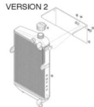
**7.18.5.** A «cortina» em acrílico original Rotax pode ser retirada. É permitido colocar uma fita ou cinta, sem qualquer publicidade, na superfície do radiador como meio de controlo do fluxo de ar. A fita ou cinta não pode ser retirada durante a corrida. Qualquer outro meio de fluxo de ar é proibido.
