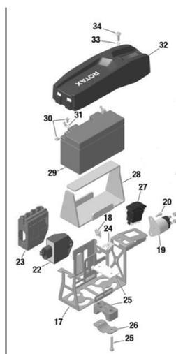
**c)** Na versão 2, ao utilizar a cablagem com referência Rotax 666836, é obrigatório utilizar o suporte de bateria com referência 251129. Na figura seguinte pode-se observar como fixar corretamente a cablagem ao suporte da bateria. Uma instalação correta da cablagem elétrica garante que as conexões entre esta e o suporte da bateria não ficam sob esforço.
