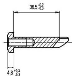
**6.5.8.** Ambas as válvulas de escape (2), sem revestimento ou de anodização dura, são permitidas.
