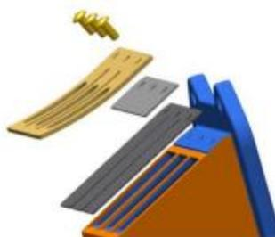
5.6.2. Os dois espaçadores têm a gravação "ROTAX", conforme o seguinte esquema. Cada espaçador tem de ser plano, sem curvatura, e cumprir com as especificações abaixo. A referência ROTAX pode estar gravada no espaçador.
