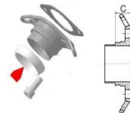
**6.15.3.1.** Só é permitido o escape original ROTAX com o cone de escape (referência Rotax 273200) e silenciador separados (referência Rotax 273220) (conforme imagem).
