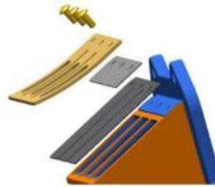
**4.8.2.** Os dois espaçadores têm a gravação “ROTAX”, conforme o seguinte esquema. Cada espaçador tem de ser plano, sem curvatura, e cumprir com as especificações abaixo. A referência ROTAX pode estar gravada no espaçador.
