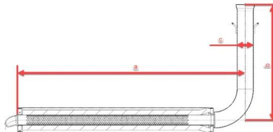
**4.4.2.3.** Uma placa sólida, medindo 28,0 mm e 1,5 mm de espessura não pode passar pela Secção "A" (assinalada na imagem seguinte), enquanto que uma esfera com um diâmetro de 26,0 mm deve atravessar o escape por completo (escape sem componentes internos).
