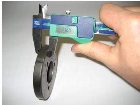
**6.8.7.2.** Altura da sapata da embraiagem (conforme imagem). A medida não pode ser inferior a 24,10 mm.
