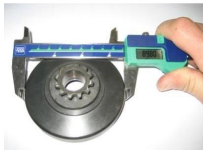
**6.8.7.4.** Diâmetro interior da campânula. A medição deve ser feita no meio (na área de contacto da campânula). O valor máximo do diâmetro interior é de 84,90 mm.
