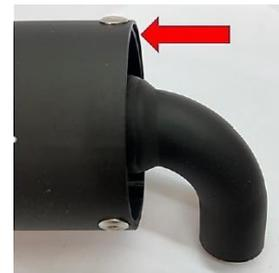
**6.15.3.7.** Caso seja necessário selar o escape, o selo terá de passar por um 4º furo com um máximo de 4 mm de diâmetro. O furo tem de estar numa posição que evite fuga de gases de escape, tal como indicado na imagem. O tubo perfurado tem de estar sempre firmemente apertado ao escape em 3 pontos.
