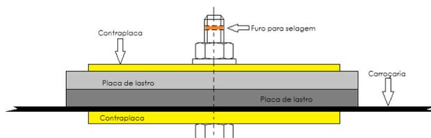
A superfície mínima de contacto entre a contra-placa e o chassis ou a carroçaria tem de ser de 40 cm<sup>2</sup> para cada ponto. Terá de ser capaz de suportar acelerações / desacelerações mínimas de 25g.
