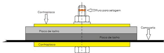
A superfície mínima de contacto entre a contra-placa e o chassis ou a carroçaria tem de ser de 40 cm<sup>2</sup> para cada ponto. Terá de ser capaz de suportar acelerações / desacelerações mínimas de 25g.
